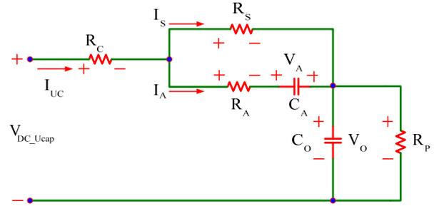
Fig. 3. LIUC EQUIVALENT CIRCUIT MODEL [13],[16]
