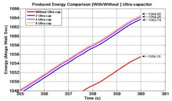
Fig. 21. DFIG ELECTRICAL ENERGY OUTPUT COMPARISON [WITH/WITHOUT UCESS] AND EFFECT OF CAPACITANCE
